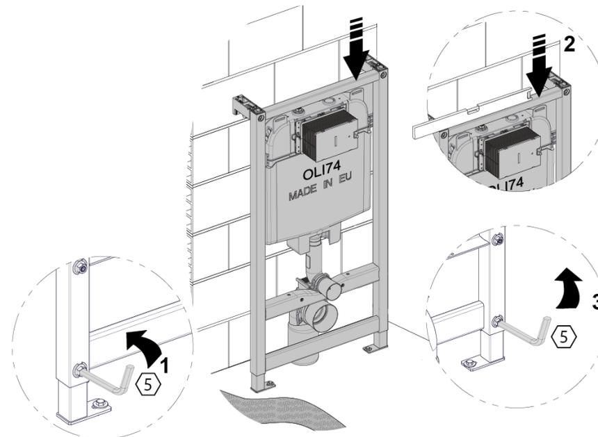
6) За счёт регулировочных стержней установить систему инсталляции в вертикальном положении и заблокировать фиксаторы стержней с обеих сторон рамы
