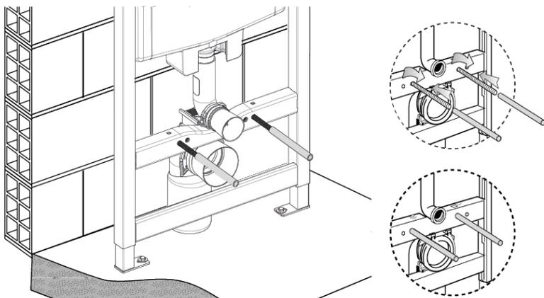
б) при необходимости можно отрегулировать глубину установки фановой трубы (от 130 до 170 мм) нажав фиксатор и перемещая держатель с фановой трубой
